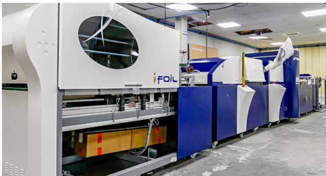
|| A fianco, la nuova nobilitatrice digitale MGI JETvarnish 3D & iFoil, arrivata in azienda durante la nostra visita. In basso, il plotter Zünd S3 con sbobinatore e mettifoglio automatico.
